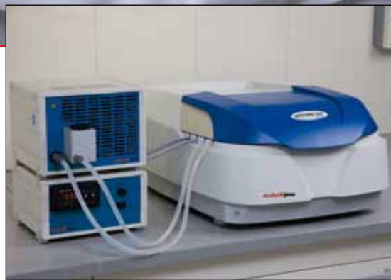
Trocador de celas com 8 posições com temperatura controlada por Peltier executando medições com alta precisão de temperatura
