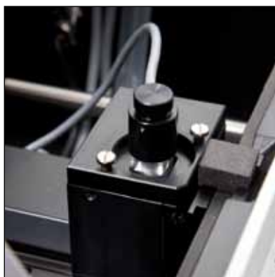
O suporte de célula com temperatura controlada por peltier garante elevada precisão na medida de temperatura; a temperatura é medida diretamente na cela.
