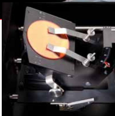
Acessório de reflectância com ângulo variável para determinação do índice de refração e espessura de filmes
