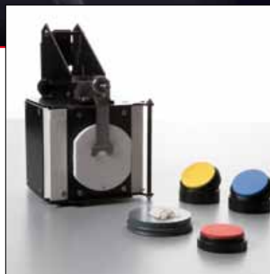
Esfera de integração para transmitância e medições de reflectância difusa
