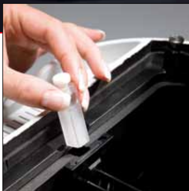
Posição para amostras turvas para medições de amostras com elevada dispersão
