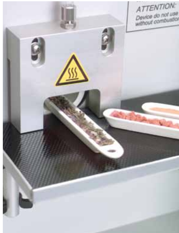
▲ HT 1300 – alimentação de amostras sólidas
